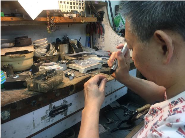
—造好金屬戒圈後，工匠便要用鑽打出用來安放鑽石的洞，再洞邊用火燒熔金屬製成幾隻爪，用來住鑽石。
