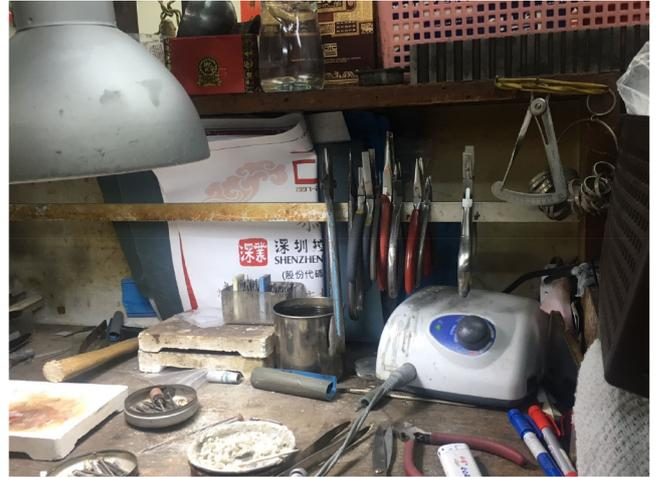
在棠哥的工作枱上，掛滿不同的古舊工具，無論是鑽戒、吊咀、手環抑或是耳環，都全靠這些工具。「以整一隻鑽戒為例，先要整一個膠模，再注蠟製成一個蠟模，放入倒模機後就會變成金屬戒圈。修飾好接口位後，就可以鑲石，再打磨拋光，最後在表面電鍍一層鉑金。」
