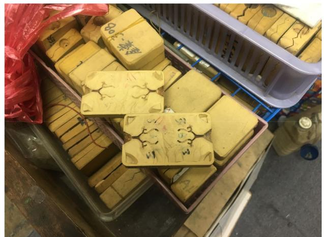
—製成膠模後就可製作大量蠟模，但隨 3D 打印普及，現時打模都改用電腦打印，這些膠模因此逐漸被淘汰。
